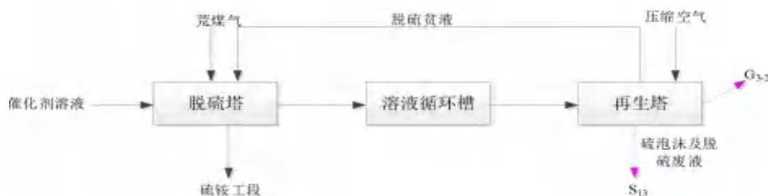
图 3.12-7 脱硫工段生产工艺流程及产污节点图
