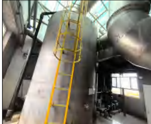
2#硫铵系统旋风除尘器+洗净塔除尘装置
